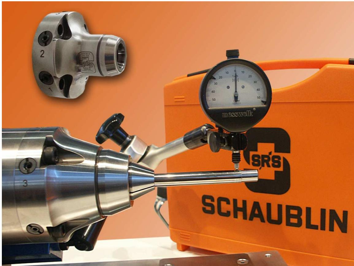
***Durch das Rundlaufregel-Systems SRS lassen sich Spannzangen auf nahezu kaum messbare Rundlauf- und Taumelfehler wiederholbar einstellen. Mit der neuen Variante SRS W 15 (links oben) ist dies nun auch bis in den Miniaturbereich ( $\varnothing$  von 0,3 mm bis 10 mm) möglich.***
