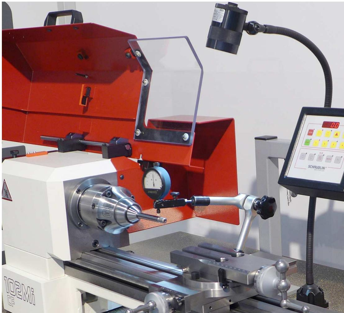
**SRS lässt sich mit verschiedensten Spannzangen und dank spezieller Flansche auf den unterschiedlichsten Maschinen einsetzen.**
